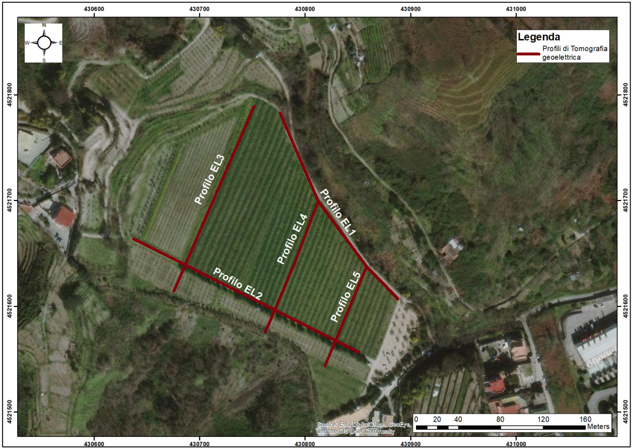
Figura 3. Napoli. Tenuta Monte Sant'Angelo. Ubicazione dei profili di tomografia geoelettrica (ERT).
